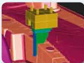
Moduł projektowania elektrod jest używany do szybkiego generowania elektrod dla modeli typu forma
